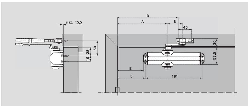
**Obs:** Ao instalar a posição 4 (UL), mova o corpo da mola 13 mm para a direção oposta às dobradiças, a partir da posição mostrada acima para o posição 4.
